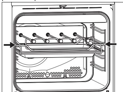
8. Dacă ceva se blochează, roțiți ușor bățul pentru frigărui din dreapta pentru a o fixa cu axul motorului și împingeți din nou.
