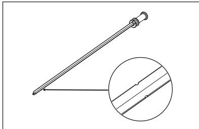
5. Helyezze be a nyársakat a hajtómű megfelelő furataiba, és helyezze a forgónyárs fogantyújának hornyát az előlő nyárstartóba. A hosszú nyársat a jobb oldali első lyukba kell beszerelni (lásd a képet).
