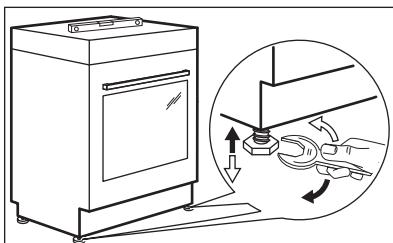
Pentru a aduce suprafața superioară a aparatului la același nivel cu celelalte suprafețe, utilizați picioarele din partea inferioară a aparatului.
