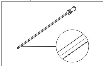
5. Introduceți ștepușele în orificiile corespunzătoare din cutia de viteze și plasați canelura mânerului rotisorului în suportul frontal al bățului pentru frigărui. Bățul pentru frigărui lung trebuie să fie împins în primul orificiu din dreapta (consultați imaginea).
